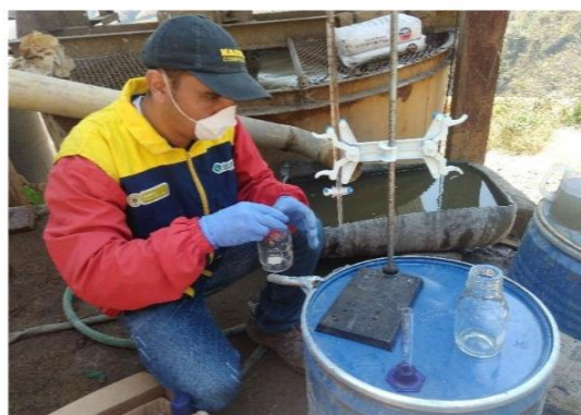
Foto No 66. Seguimiento Proceso cianuración en agitación lectura de concentración de Cianuro en proceso y soluciones de neutralización
