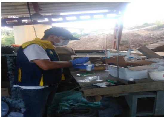
Foto No 66. Seguimiento Proceso cianuración en agitación lectura de concentración de Cianuro en proceso y soluciones de neutralización
