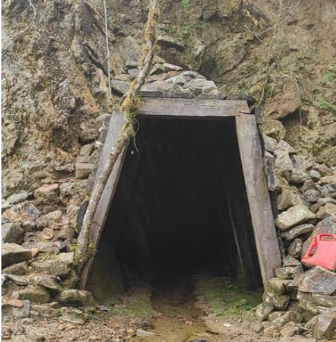
Bocamina Inactiva, profundidad 100 mts. Soporte en puerta alemana, roca de competencia alta- Mina la Bombona Nueva – Mallama.
